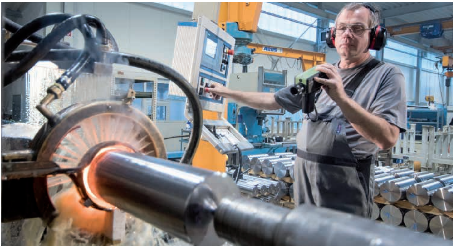
Stimmt die Temperaturverteilung? Martin Prause kontrolliert das an seiner Härteanlage per Wärmebildkamera.
